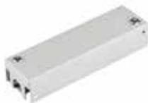
Предназначен для ответвления волокон из межэтажного кабеля с сердечником свободного доступа, фиксации межэтажного кабеля и транспортных трубок, защиты места ответвления. Изготовлен из стали, имеет компактные размеры, может устанавливаться непосредственно в стояках, этажных шкафах, нишах и т. п.
