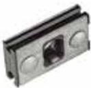
Предназначен для подвески кабеля с вынесенным силовым элементом диаметром от 4 до 9 мм. Для крепления кабеля и троса в корпусе зажима имеются две канавки. Состоит из двух зажимных щек из УФ-стойкого термопластика, усиленных двумя стальными оцинкованными пластинами.
