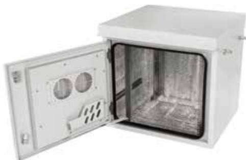
Предназначен для размещения активного и пассивного телекоммуникационного оборудования в сложных климатических условиях внешней окружающей среды. Выполнен в климатическом исполнении У1 (опционально УХЛ1 по ГОСТ 15150-69) и предназначен для эксплуатации на улице, а также внутри помещений при температуре от  $-45$  до  $+40$  °С. Верхнее рабочее значение относительной влажности – 98% при температуре 25 °С. Степень защиты IP65 (с установленным кондиционером или вентиляторным модулем – IP55).
