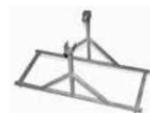
Предназначена для установки на нее барабана ЛСИ и представляет собой силовую сварную конструкцию с прямоугольным рамным основанием и боковыми стойками. В верхней части расположены вилки с фиксатором для установки барабана. В основании подставки предусмотрены четыре штыря для закрепления на грунте.
