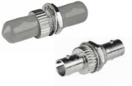
Адаптер ST предназначен для соединения оптических разъемов. Корпус розетки сделан из никелированной латуни. Стыковка наконечников оптических соединителей осуществляется при помощи прецизионной центрирующей втулки, изготовленной из циркониевой керамики или бронзы. Фиксация розетки ST-типа на адаптерную планку осуществляется с помощью шайбы-гровер и гайки. Адаптеры комплектуются пластиковыми колпачками для защиты от пыли до установки в них коннекторов.
