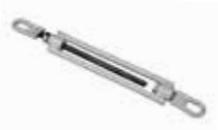
Предназначен для регулировки длины натяжной подвески самонесущих оптических кабелей городских и сельских линий. Плавность изменения длины талрепа позволяет точно регулировать стрелы провеса оптического кабеля.
