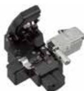
Скальватель разработан для сетей FTTH и предназначен для скалывания оптических волокон. Укомплектован пластиной AD-10 для укладки одиночного волокна с покрытием 250 и 900 мкм. Шкала позволяет варьировать длину скола от 5 до 20 мм. В стандартную комплектацию скальвателя входит устройство для сбора остатков сколотого оптического волокна. Имеет круглое лезвие.
