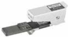
Портативный скалыватель Fujikura CT-02 позволяет быстро и качественно сколоть одиночное волокно в полевых условиях, например для подключения неоконцованного кабеля к разъему измерительного прибора с помощью устройства УПОВ. Скалыватель оснащен шкалой в миллиметрах для визуального контроля длины скола волокна в диапазоне от 6 до 19 мм. Сменный нож имеет ресурс не менее 1000 сколов. Благодаря простейшей конструкции имеет очень низкую цену.
