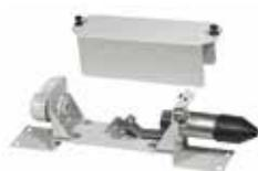
Предназначен для организации ввода магистрального оптического кабеля в корпуса оптических кроссов и обеспечивает удобство и качество монтажа. Корпус и защитный кожух ВКУ выполнены из листовой стали и имеют лакокрасочное покрытие. Конструкция ввода позволяет осуществлять заземление брони оптического кабеля и его центрального силового элемента. Конструкция ВКУ предусматривает вывод оптических модулей кабеля в полимерной гофротрубе.
