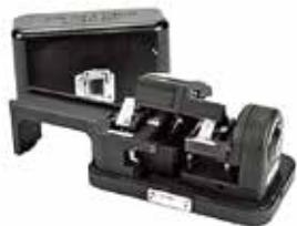
Предназначен для углового скалывания оптических волокон при монтаже механических соединителей Fibrlok™ 2529-AS и угловых неполируемых коннекторов NPC 8800 SC/APC и NPC 8802-T SC/APC. Позволяет обеспечить высокие характеристики соединения в широком температурном диапазоне. Применяется с волокнами как в 250 мкм, так и 900 мкм буфере.
