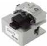
Предназначен для скалывания оптических волокон. Оснащен системой компенсации ударной нагрузки на волокно. Это значительно повышает качество скола, приближая его к ультразвуковому. Система демпфирования снижает нагрузку на лезвие, что позволяет уменьшить его износ на 25%.
