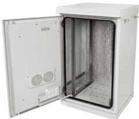
Предназначен для размещения активного и пассивного телекоммуникационного оборудования в сложных климатических условиях внешней окружающей среды. Выполнен в климатическом исполнении У1 (опционально УХЛ1 по ГОСТ 15150-69) и предназначен для эксплуатации на улице, а также внутри помещений при температуре от минус 45 до плюс 40 °С. Верхнее рабочее значение относительной влажности – 98% при температуре 25 °С. Степень защиты IP65 (с установленным кондиционером или вентиляторным модулем – IP55).
