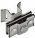
Предназначен для подвески кабеля с вынесенным силовым элементом из стали, сплава алюминия или полимера средней или высокой плотности, диаметром от 4 до 9 мм (два инверсивных отверстия).
