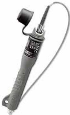
Предназначен для инспектирования оптического волокна или патч-корда. Прочная резиновая оболочка надежно защищает прибор от влаги и сотрясений, а двух стандартных AAA батареек хватает на 50 часов непрерывной работы. Имеет эргономичный дизайн и пыле-влагозащищенное исполнение. Комплектуется универсальным адаптером 2,5 мм.
