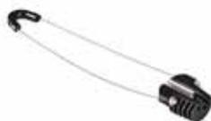
Предназначен для крепления и поддержки кабеля с обеспечением требуемого натяжения кабельной линии. Состоит из открытого конического корпуса, пары металлических или пластиковых зубчатых клиньев, образующих зажимное устройство, и гибкой петли. Все детали соединены между собой и не могут быть утеряны. Зажим позволяет значительно снизить затраты времени в процесса подвеса кабеля.
