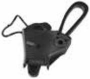
Предназначен для крепления медножильных абонентских кабелей круглого или плоского сечения. Состоит из корпуса с пластиковой петлей, защелкиваемой при креплении к опоре, и вкладкой-клином с канавкой круглого сечения. Натяжение кабеля регулируется затягиванием кабельной петли с клином в корпусе зажима. Зажим выполнен из УФ-стойкого термопластика.
