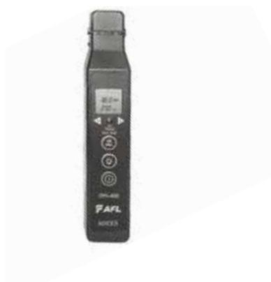
OFI 400 предназначен для обнаружения оптических сигналов, передаваемых по одномодовым оптическим волокнам, без нарушения трафика. Идентификатор формирует на исследуемом волокне незначительный изгиб, благодаря которому часть оптического сигнала выходит за оболочку волокна. Сигнал детектируется и производится индикация одного из следующих состояний: «НЕТ СИГНАЛА», «ТОНОВЫЙ», «ТРАФИК».
