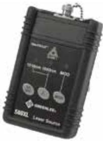
Источник излучения 570XL – это лучшее решение для тестирования вносимых потерь на многомодовом оптическом кабеле. Прибор работает на двух длинах волн и может обеспечивать непрерывный выходной сигнал в процессе измерения. 570 XL имеет три типа исполнения: с FC, SC и ST коннекторами.
