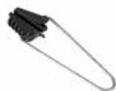
Предназначен для быстрого крепления самонесущего оптического кабеля круглого сечения диаметром от 5 до 7 мм, а также кабеля с вынесенным силовым элементом из проволоки, троса или стеклоплетки. Пролет между точками крепления – до 50 м. Состоит из пластикового корпуса, устойчивого к морозам, полимерных клиньев и стальной оцинкованной петли.
