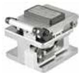
Предназначен для скалывания оптических волокон при подготовке оптического волокна к сварке. В FC-6S основное внимание уделено элементам, определяющим качество скола, и убраны второстепенные элементы конструкции, такие, например, как специальные блоки для сбора осколков волокна. Обладает высокой надежностью и ресурсом в 36 000 сколов. Предусмотрена замена лезвий.
