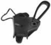
Предназначен для крепления медножильных абонентских кабелей плоского сечения. Состоит из корпуса с пластиковой петлей и вкладкой-клином с канавкой прямоугольного сечения. Натяжение кабеля регулируется затягиванием кабельной петли с клином в корпусе зажима. Позволяет выполнять терминирование линии для подключения абонента или подвеску абонентского кабеля. Зажим выполнен из УФ-стойкого термопластика.
