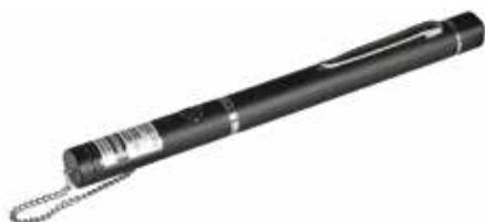
Имеет стабильную выходную оптическую мощность при двух режимах работы: непрерывный и импульсная модуляция. Излучение может передаваться по оптическому волокну на расстояние от 9 до 13 км.
