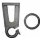
Предназначен для использования в сочетании с поддерживающим зажимом и может использоваться на любых опорах сети освещения и контактной сети, а также для монтажа на стене здания. Данный кронштейн может крепиться двумя ленточными хомутами, либо анкерным болтом, шпилькой М14, М16.
