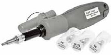
Предназначен для быстрой проверки состояния оптических портов и патч-кордов. Благодаря небольшим габаритам FOD-6003 позволяет контролировать труднодоступные коммутационные панели. Прибор прост в работе: достаточно подключить его к разъему и нажать на кнопку. Прибор имеет автоцентрировку, автофокусировку и автоматический анализ качества разъема на соответствие стандартам. Есть функция «Годеи/Не годеи» и возможность автоматического создания отчетов в формате PDF.
