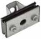
Предназначен для подвески кабеля с вынесенным силовым элементом диаметром от 4 до 9 мм на опорах всех типов. Для крепления кабеля и троса в корпусе зажима имеются две канавки, которые предохраняют кабель от повреждения при сверхнормативной вертикальной нагрузке.
