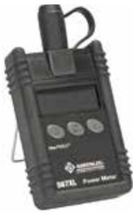
Greenlee 560XL – измеритель мощности оптического сигнала в одномодовых и многомодовых системах связи. Прибор выполнен в компактном прорезиненном корпусе, благодаря чему удобен как на этапе инсталляции, так и в ходе эксплуатации ВОЛС. Применяется для измерения оптической мощности или тестирования вносимых потерь в оптическом кабеле совместно с лазерным или светодиодным источником излучения.
