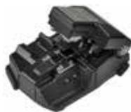
Предназначен для скалывания оптических волокон. Имеет большой угол между рычагом и основанием скальвателя для более удобной укладки волокна, а также устройство автоматического перемещения ножа. Работает с ленточными волокнами при использовании специальных держателей.
