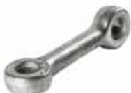
Предназначено для увеличения и регулирования длины подвески, перехода от одного вида соединения к другому, изменения расположения оси шарнирности элементов подвески, рассчитанной на разные нагрузки. Состоит из круглого стержня, имеющего на концах проушины, которые повернуты на 90° относительно друг друга.
