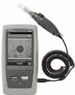
Предназначен для быстрой проверки состояния оптических портов и патч-кордов. Способен автоматически сертифицировать состояние коннектора по принципу «Прошел/Не прошел». Данная модель имеет графическую индикацию проблемных зон, загрязнений и повреждений поверхности. Есть возможность сертификации коннекторов в соответствии стандартам – IEC 61300-3-35, а также сохранения изображения состояния поверхности коннекторов. Вся информация выводится на большой сенсорный экран.
