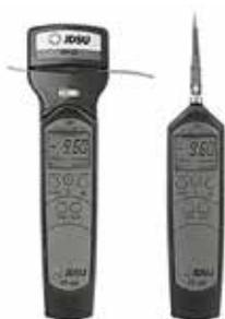
Идентификатор активного волокна FI-60 – это измеритель мощности и идентификатор оптической мощности в одном устройстве.
