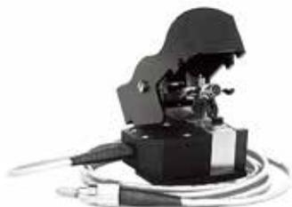
Ответвитель-прищепка FOD-5503 обеспечивает двунаправленное подключение к одномодовому волокну в 250-микронном покрытии без повреждения волокна. Ответвитель совместим с оптическими телефонами и другими волоконно-оптическими приборами. Используется для технического обслуживания, идентификации волокон и звуковой связи. Обеспечивает возможность подключения волоконно-оптических переговорных устройств в любой промежуточной точке волоконной линии, там, где есть доступ к волокну.
