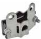
Предназначен для подвески кабеля с вынесенным силовым элементом от 4 до 9 мм. Состоит из двух зажимных щек из УФ-стойкого термопластика, усиленных стальными оцинкованными пластинами. В корпусе зажима имеются канавки для крепления кабеля и троса.
