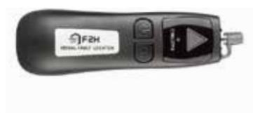
Предназначен для инспектирования оптического волокна или патч-корда. С его помощью можно визуально установить место повреждения оболочки волокна. Устройство излучает красный свет на длине волны 650 нм, видимый человеческим глазом. Место повреждения волокна или оболочки светится красным цветом. Работает с одномодовым и многомодовым волокном, имеет эргономичное исполнение и маленький размер и вес. Дальность действия от 5 до 15 км.
