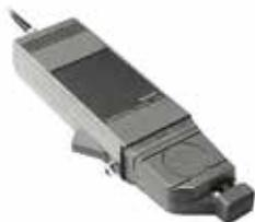
Устройство Photom 550 для ввода/вывода сигнала на изгибе оптического волокна позволяет подключить оптический телефон серии Photom 450 в опто-волоконную линию без разрыва волокна.
