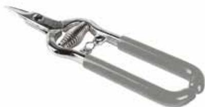
Инструменты изготавливаются из высокоуглеродистой стали и предназначены для резки упрочняющих нитей оптоволоконного кабеля, а также изолирующих и других прочных материалов, используемых в промышленности и электронике.
