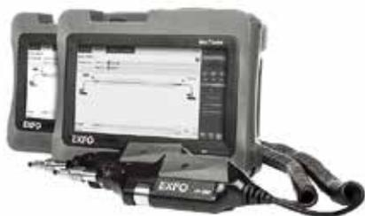
Оптические тестеры MAX-940/945 позволяют полностью в автоматическом режиме провести двухсторонний тест волоконно-оптической линии. В сочетании с автоматическим микроскопом для исследования качества ферул и поддержки технологии FasTesT™ (запуск теста одним нажатием), данные приборы незаменимы для оценки качества ВОЛС. Дальность измерений приборов 200 км (SM) и 20 км (MM).
