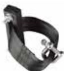
Предназначен для подвески кабеля с вынесенным силовым элементом из стали, сплава алюминия, полимера средней или высокой плотности. Используется для кабелей диаметром от 4 до 10 мм (два инверсных отверстия) на проходных опорах при длине пролетов линии до 100 метров.
