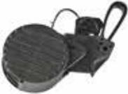
Предназначен для крепления медножильных абонентских кабелей, круглого или плоского сечения. Состоит из корпуса с пластиковой петлей, вкладкой-клином с канавкой круглого сечения и защитного блока. Натяжение кабеля регулируется затягиванием кабельной петли с клином в корпусе зажима. В защитном блоке размещают разъем, соединяющий наружный и внутренний абонентские кабели, после чего он закрепляется на корпусе зажима. Зажим выполнен из УФ-стойкого термопластика.
