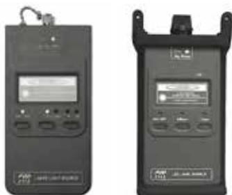
FOD-2112 обеспечивает излучаемую оптическую мощность 0,5 мВт (-3 дБм) в одномодовом или многомодовом волокне на длинах волн 1310 и 1550 нм. FOD-2115 обеспечивает излучаемую оптическую мощность 10 мкВт в многомодовом волокне на длинах волн 850 и 1310 нм. Приборы комплектуются сменными адаптерами FC, по заказу могут быть укомплектованы адаптерами ST, SC и другими.
