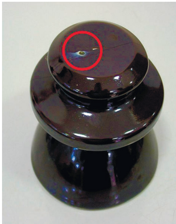
Рис. 6. Сквозной пробой штыревого изолятора
